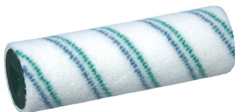
Rouleau à peinture en fibres nylon ondulées et traitées résistant aux solvants. Bonne absorption de la peinture et restitution uniforme. Pratiquement pas d'éclaboussures, ne se feutre pas et facile à nettoyer, 6 mm de hauteur de poil pour une finition lisse.
