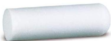
Rouleau à peinture en mousse CFC et sans solvants de 55kg/m<sup>3</sup>. Particulièrement recommandé pour une finition parfaite et une bonne répartition de la peinture grâce à sa structure extra fine. Convient aux laques avec un long temps ouvert. Les deux côtés arrondis permettent d'enlever les traces de rouleau.
