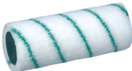
Rouleau à peinture en fibres nylon ondulées et traitées résistant aux solvants. Bonne absorption de la peinture et restitution uniforme. Pratiquement pas d'éclaboussures, ne se feutre pas et facile à nettoyer, 11 mm de hauteur de poil pour plus d'épaisseur de couche et une finition légèrement structurée.
