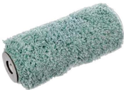
ANZA PRO Platinum vert MICMEX: pour les surfaces lisses à moyennement lisses et un résultat lisse. Il est composé de polyester et de microfibras, à poils hauts et possède une très grande capacité d'absorption et de libération. Il est spécialement développé pour toutes les peintures pour plafonds et murs, donne une belle saturation et très peu de texture.
