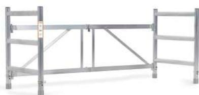
L'adaptateur Basic 75-3 est un élément pliant qui permet de surélever l'échafaudage pliant Basic de 3 échelons. Ceci permet de réaliser une hauteur de travail de 385 cm. Tubes à bride nécessaires, inclus dans la livraison. Ce produit est une combinaison des pièces d'extension avec les colliers de liaison correspondants.
